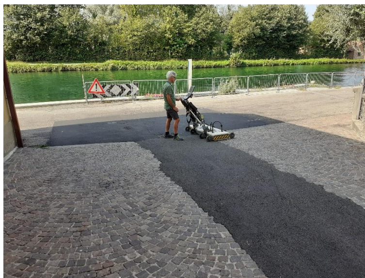
Figura 40 – Ripresa fotografica dell'attività di rilievo georadar condotto.
